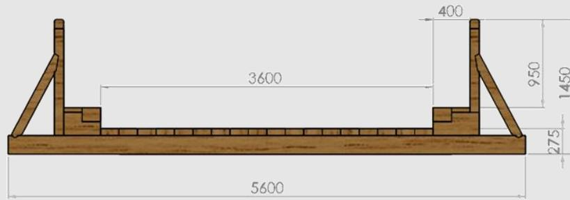
Imagen 23: Vista transversal tablero para puente sobre vigas metálicas - ancho de calzada 3,6 m
