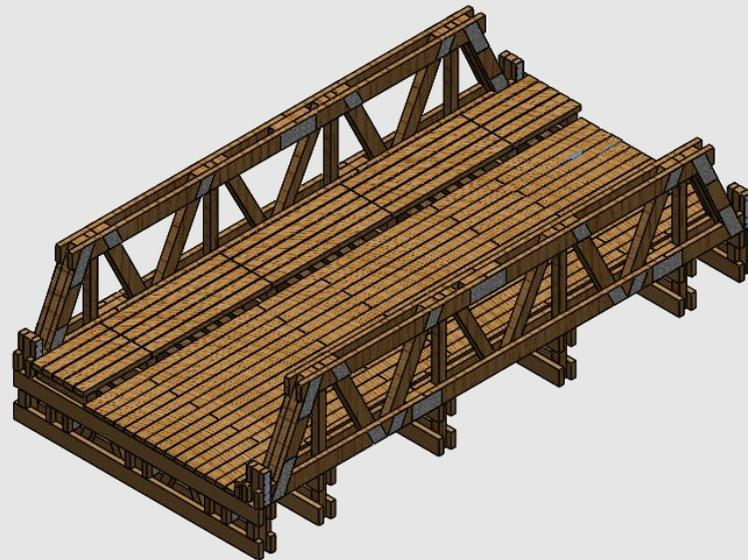
Imagen 19: Vista isométrica puente 10 m unidireccional.
