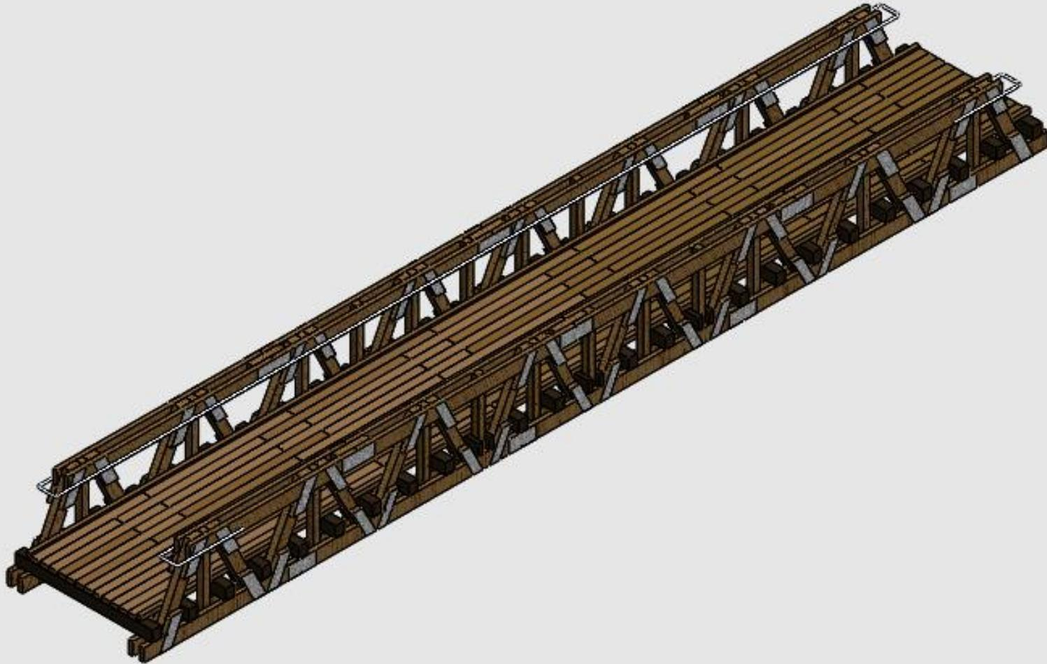
Imagen 20: Vista isométrica longitudinal pasarela peatonal de 20 m.
