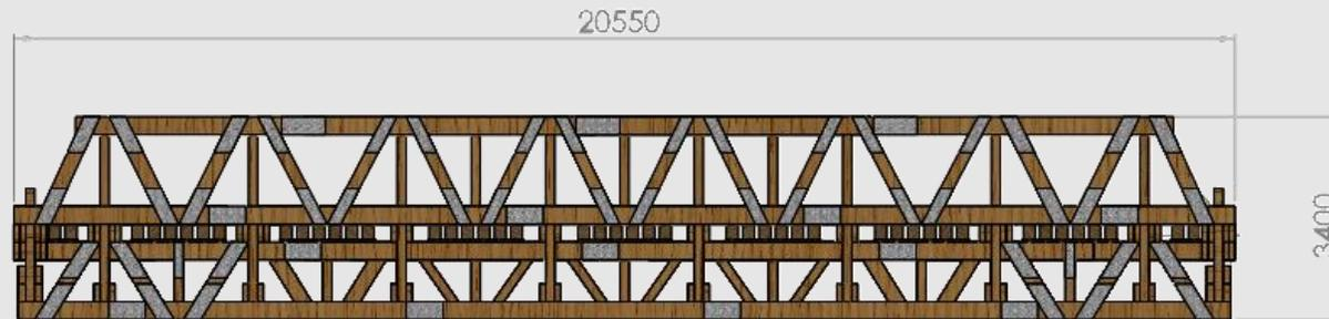
Imagen 3: Vista Longitudinal del puente Huapi (20 m).
