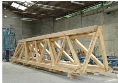
Fig.4.7 Cercha de cubierta
