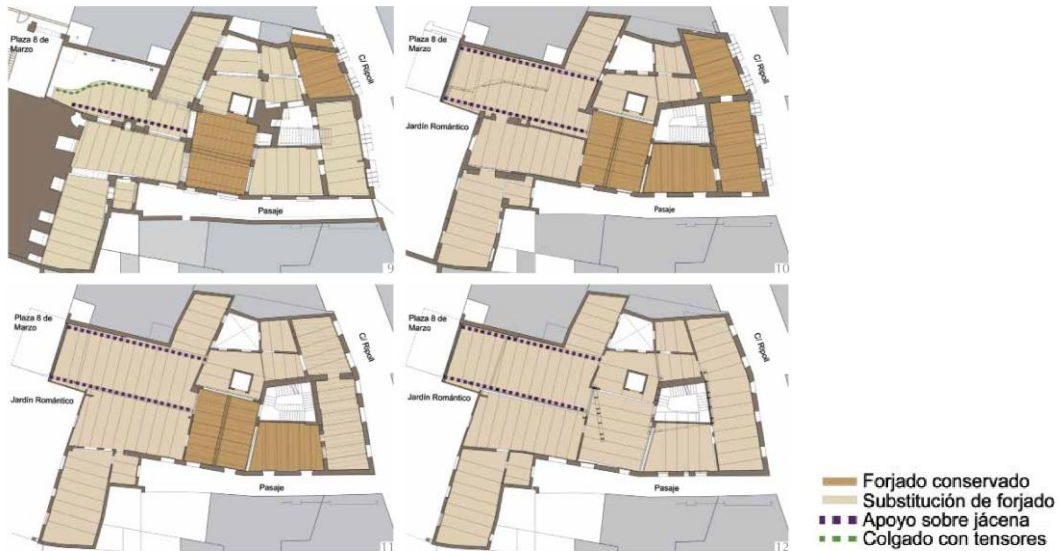
Fig.3.8 Panorama de rehabilitación de forjados
